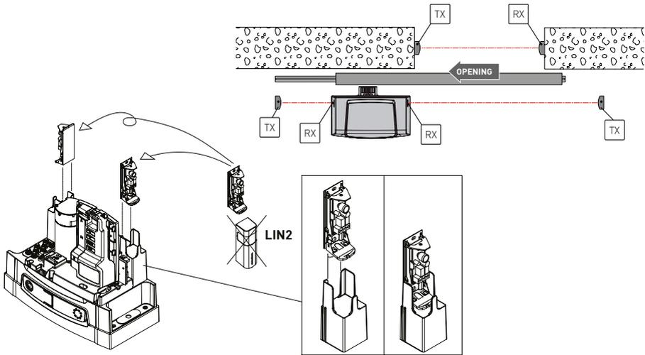
Il est possible d'installer des cellules photoélectriques supplémentaires dans le carter de Ditec NEOS, pour la protection aussi bien du mouvement de fermeture que du mouvement d'ouverture, en utilisant la cellule photoélectrique LIN2.
